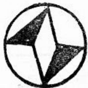
ТРУБКА ЭЛЕКТРОННОЛУЧЕВАЯ ОСЦИЛОГРАФИЧЕСКАЯ
