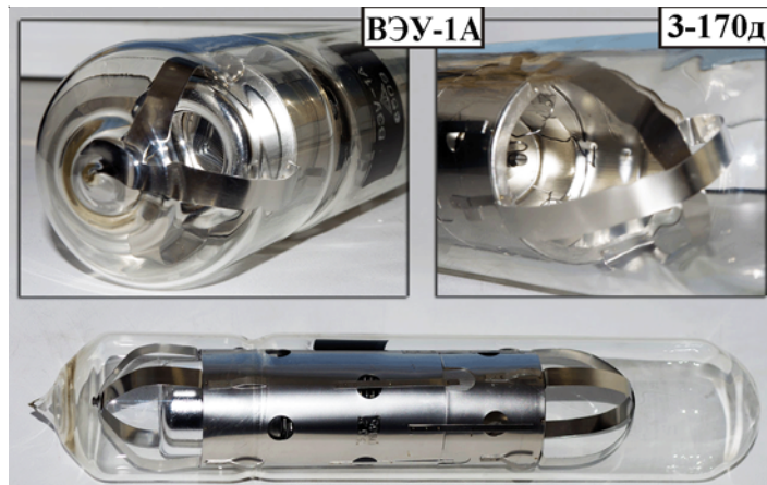
Рис. 3.2.2.1. Внешний вид, габаритные размеры, и схемы включения вторично-электронных умножителей
