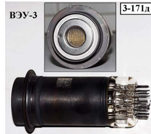
Рис. 3.2.2.1. Внешний вид, габаритные размеры, и схемы включения вторично-электронных умножителей
