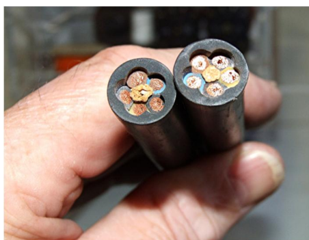
Bild 27 a/b Fernsehkamera FB3/2/1 Stromversorgungskabel-Querschnitte
