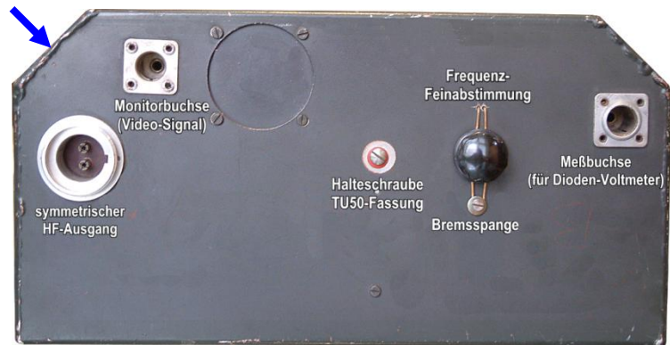
Bild 32 Frontseite des Senderbausteins
