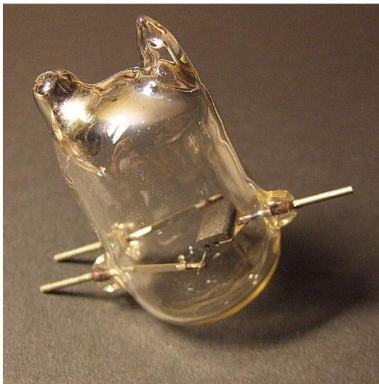
Bild 58 a/b Modulationsdiode DU 10/1 Rechts: freitragende Einspannung der Modulationsdiode gelber Pfeil: Klemmscheiben für die Heizspannungsanschlüsse, Schwarzer Pfeil: Anodenstift in Kelchfeder der Lecherleitung
