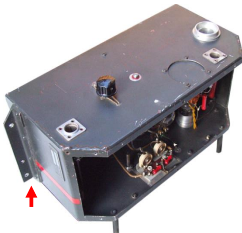
Bild 31 Bauteilechassis des Bildsenders Links: Front- und Oberseite Rechts: Chassis mit allen Bauelementen
