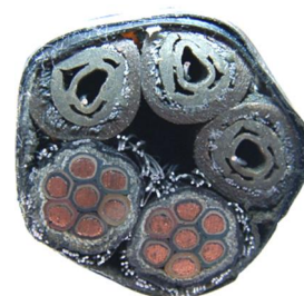
Bild 106 Querschnitt durch das Verbindungskabel zu den Betriebsspannungen und (vermutlich) zum TV-HF-Teil des »Seedorf III«
