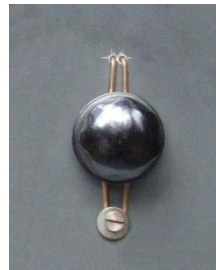
Bild 52 Drehknopf und Federspange für die Abstimmzscheibe der Frequenz- Feinabstimmung
