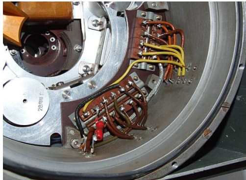
Bild 101 a/b »Seedorf III« Durchführungen und Verbindungsstecker vom nicht luftdichten Bauteilefach in den Innenraum des Monitors Pfeil: Glasdurchführungen in der Seitenwand des Gussringes der vorderen Baugruppe (A)
