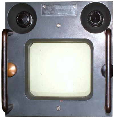
Bild 84 a/b Zielweisungs-Sichtgerät (Bildschreiber) ähnlich »Seedorf I« Typenschild: FB NFE/3 Fernbild Niederfrequenz-Empfänger 3 (?)
