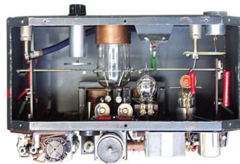
Bild 31 Bauteilechassis des Bildsenders Links: Front- und Oberseite Rechts: Chassis mit allen Bauelementen
