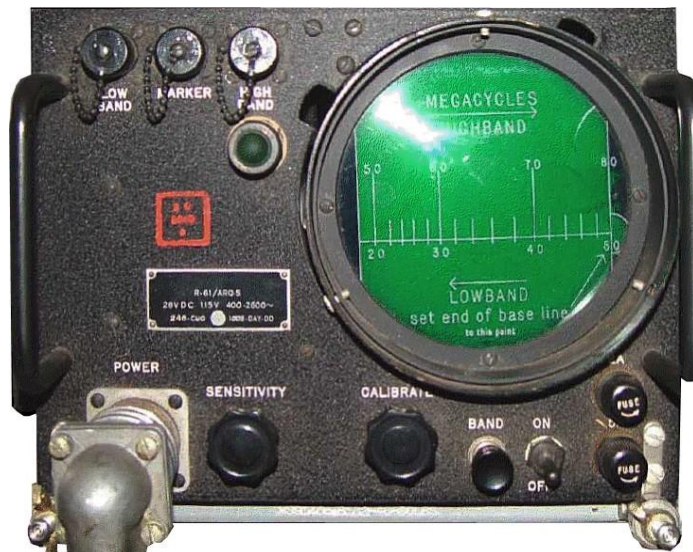
Bild 136 Panorama-Adapter R61/ARQ5 20–50 und 50–80 MHz
