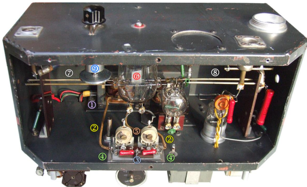
Bild 47 HF-Baugruppe mit Lechersystem
