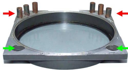
Bild 93 »Seedorf III« Frontabdeckung mit Frontscheibe Rote Pfeile: Durchführungshülsen Grüne Pfeile: Durchbrüche für Regler
