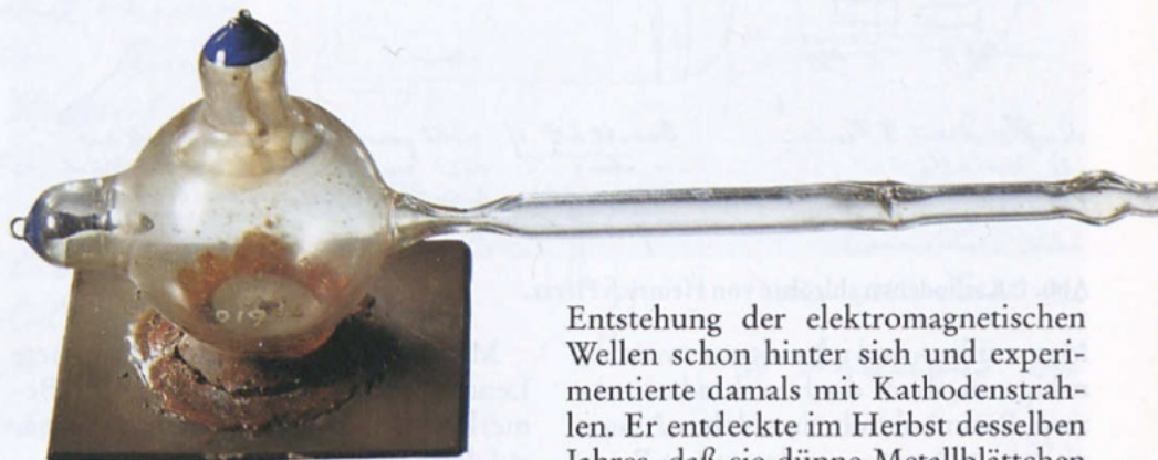
Lenard-Röhre mit dünnem Metallfensterchen, um 1892.
