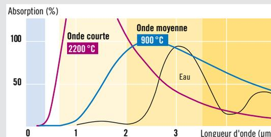
L'eau est vaporisée efficacement par des émetteurs infrarouges à ondes moyennes car dans cette plage, le pouvoir d'absorption de l'eau est très bon.
