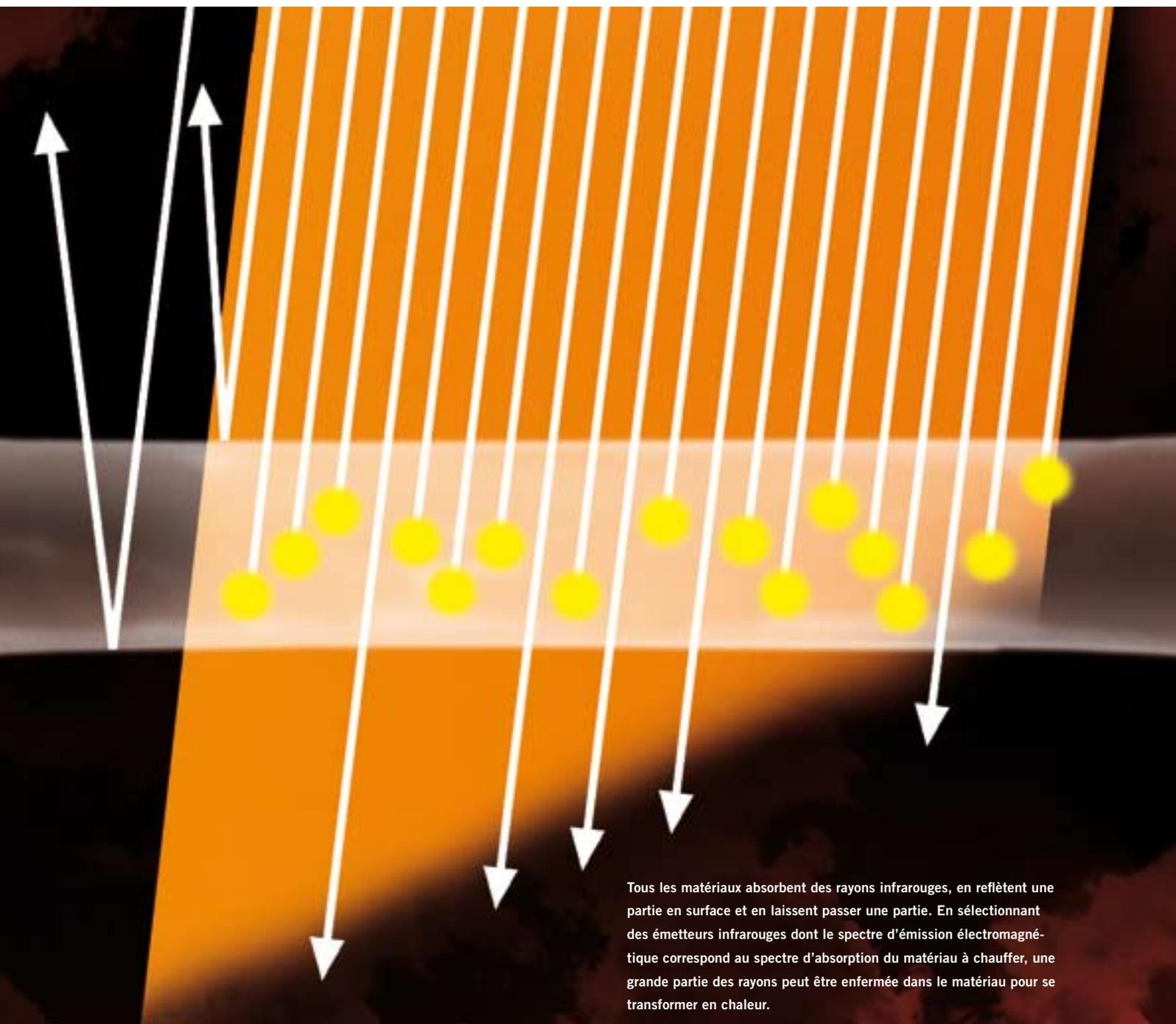
Tous les matériaux absorbent des rayons infrarouges, en reflètent une partie en surface et en laissent passer une partie. En sélectionnant des émetteurs infrarouges dont le spectre d'émission électromagnétique correspond au spectre d'absorption du matériau à chauffer, une grande partie des rayons peut être enfermée dans le matériau pour se transformer en chaleur.
