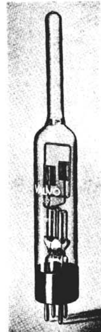
Abb. 3. Abhängigkeit des durch die Röhre fließenden Stromes vom Gasdruck Abb. 4 (rechts). Ansicht des Valvo-Vakuummeters 95 322
